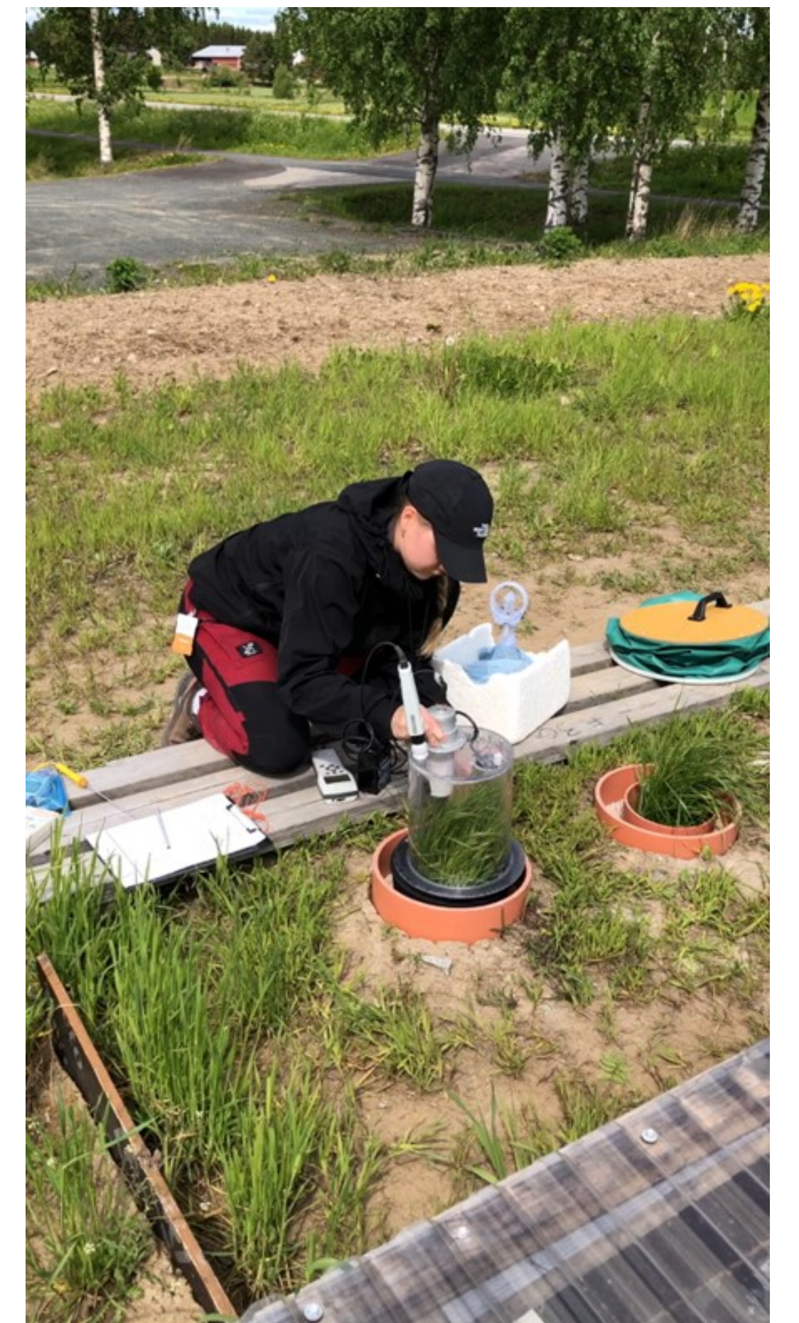
Kuva 1. Mesokosmoksen poikkileikkaus ja kaasuvuon mittaus kammiomenetelmällä (Kuva Yu Zheng)
